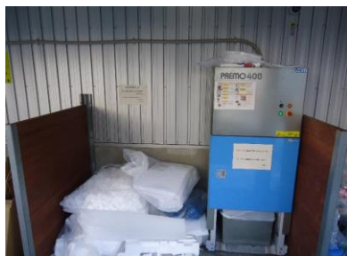
ごみ圧縮機で体積換算で65%削減目標
